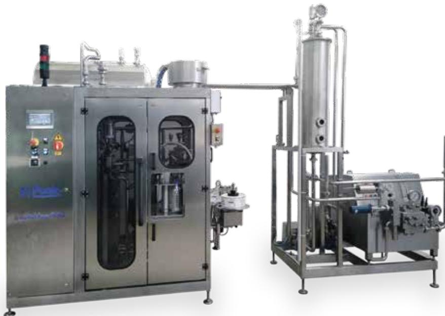
Evolution 500 completa di omogeneizzatore e degasatore.
