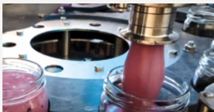
DOSING SYSTEM SISTEMA DI DOSAGGIO
